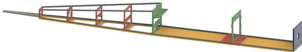
Abbildung 2: Aufbau der Spanten und Gurte
