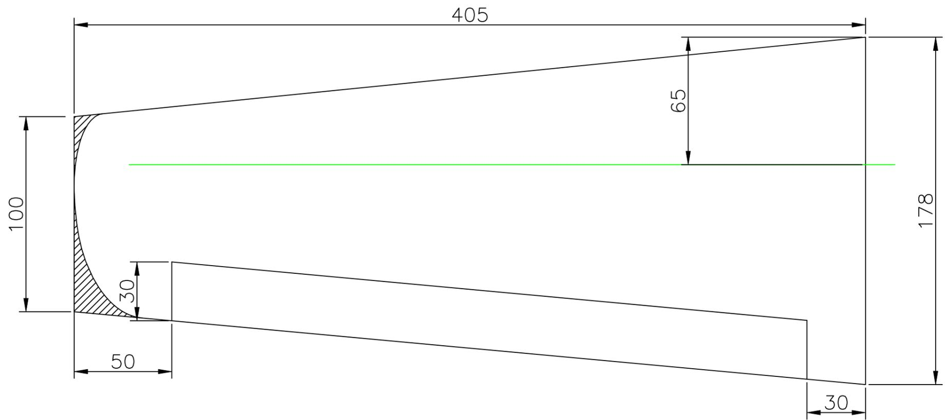
An den grünen Linien werden die 3x0,3mm CfK Profile im Schaum versenkt. An der Tragfläche müssen die Profile an Unter- und Oberseite ca 10mm herausragen, damit sie miteinander verklebt werden können.
