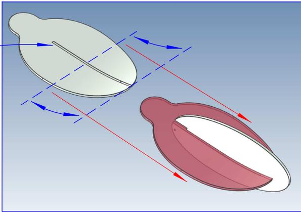
Biege die Hinterkante des horizontalen Rumpf-Bauteils ein wenig nach oben, so dass es genau in den Ausschnitt im senkrechten Teil passt.
