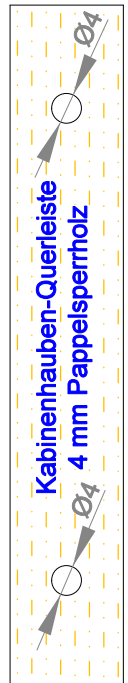
Bohrungen für Zylindermagnet (4 mm x Ø 4 mm)
